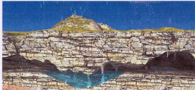
Imagen: Representación gráfica de la filtración de agua hacia el subsuelo y manto freático en las regiones kársticas
